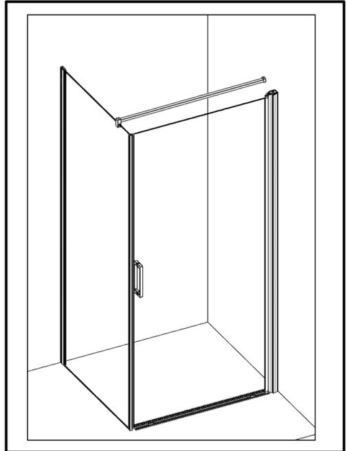
**F** Vous avez la possibilité de réaliser un montage à droite ou un montage à gauche. Notre notice d'installation décrit un montage à gauche. Si vous voulez réaliser un montage à droite, il vous suffit d'inverser le montage.
