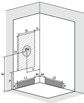
Bei quadratischen Modellen kann sich der Wassereinlaufbereich auch an der zweiten Wand befinden
