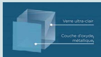
Afin d'encore augmenter le confort quotidien, le verre n'est pas seulement protégé contre le vieillissement, mais bien aussi contre le calcaire. L'eau perle sur les surfaces traitées contre le calcaire, réduisant les dépôts de calcaire gênants sur le verre.
